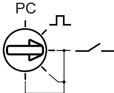
Figura 4: Interruttore modalità di funzionamento
