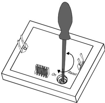
3. Kople apparatet til busstilkopleren igjen. IR-lageret slettes. Som bekrefteelse blinker IR-vinduet oransje.
