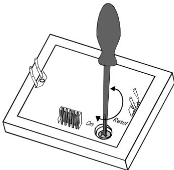
3. Stecken Sie das Gerät wieder auf den Busankoppler auf. Der IR-Speicher wird nun gelöscht. Als Bestätigung blinkt das IR-Fenster orange.
